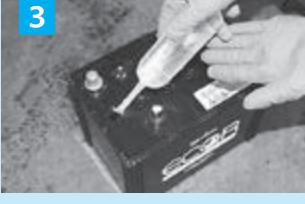
**③**液面が低下していたら、最高液面線（UPPER LEVEL）を超えないよう気を付けながらバッテリー補充液（精製水）を注入します。
