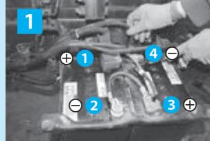
**①**充電済のバッテリーをセットし、「ダンプ(トラック)」のバッテリーの取り外し方法①」と逆の順番でバッテリーターミナルを取り付けます。**①**の赤いカバーがついている極が $\oplus$ となるのでそれを目安にします。
