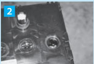
**②**液口栓の中を見て、液面が低下していないか確認します。
