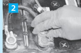
**②**バッテリーターミナルがしっかり固定できているか手で確認し、バッテリーカバーを取り付けて完成です。
