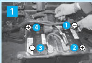
**①**バッテリーカバーを外してから、工具でバッテリーターミナル（バッテリー端子に接続して配線をつなぐための金具）を図の①から④の順番で外します。
