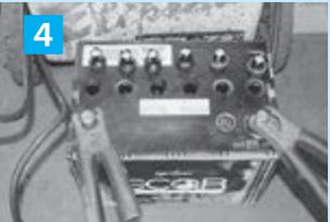
**④**充電器の赤いコードをバッテリーの $\oplus$ 端子に、黒いコードを $\ominus$ 端子につなぎ、充電器の電源を入れて充電します。充電量が90%を超えたたら充電器の電源を切つてコードを外し、液口栓を全て閉めて完了です。
